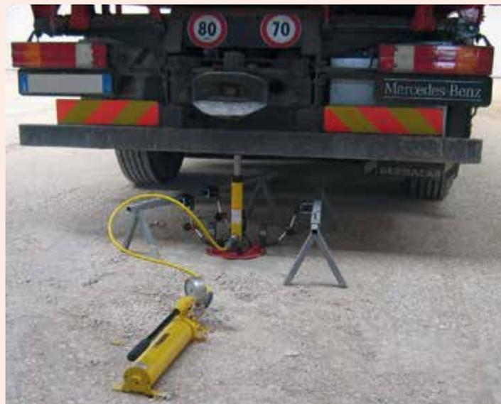
Immagini di una tipica prova di carico su piastra per determinare il modulo Md di un pacchetto di posa.
